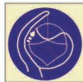
SM-10 Suelten trincas
